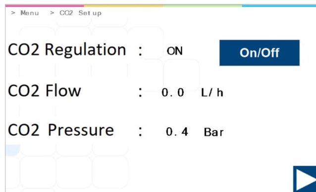
13.25 pav. MIRI® TL6 ir MIRI® TL12 daugiakamerio IVF inkubatoriaus CO 2 nustatymo antrinio meniu rodinys
