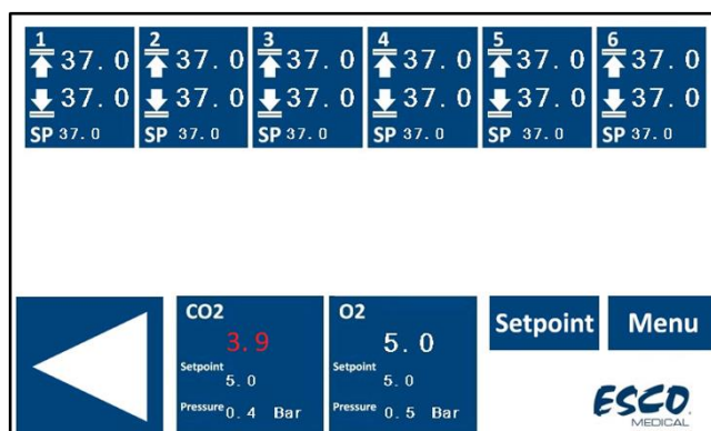
14.5 pav. Mažos CO 2 koncentracijos įspėjamojo signalo rodinys MIRI® TL6 daugiakamerio IVF inkubatoriaus pagrindiniame ekrane
