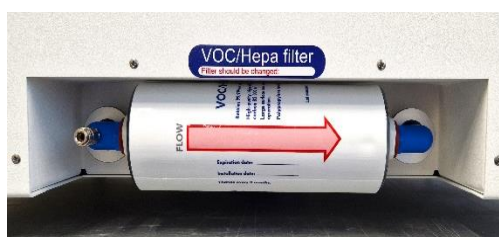
12.3 pav. Tinkamai įdėtas LOJ ir HEPA filtras
