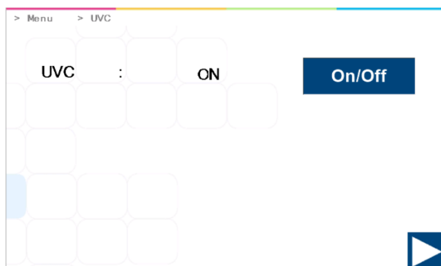
13.28 pav. MIRI® TL6 ir MIRI® TL12 daugiakamerių IVF inkubatorių UV-C lempos reguliavimas
