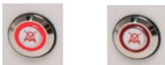
14.1 pav. Įspėjamojo signalo mygtukas, rodantis įspėjamojo signalo būseną
