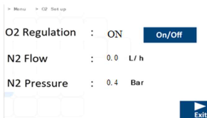
16.4 pav. MIRI® TL6 ir MIRI® TL12 daugiakamerio IVF inkubatoriaus O 2 nuostatų antrinio meniu rodinys
