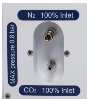
11.1 pav. Dujų tiekimo angos
