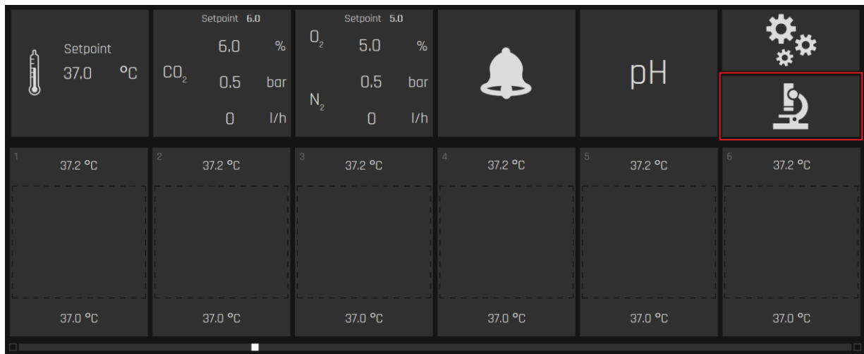
20.30 pav. Tikralaikio vaizdo režimo mygtukas MIRI® TL6 ir MIRI® TL12 daugiakamerių IVF inkubatorių pagrindiniame ekrane
